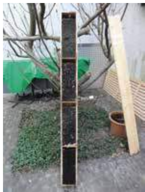
Eine seit Oktober 2014 mit Erde gefüllte Stütze wird anfangs Februar 2015 begutachtet.
